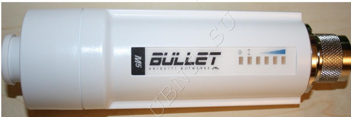
1 . Подключаем **Bullet** к устройству PoE (порт Power Over Ethernet), порт LAN подключаем к локальной сети либо непосредственно к компьютеру! Внимание! Сначала подключите все провода к устройствам (порт PoE, порт LAN к локальной сети либо непосредственно к компьютеру только после этого подключит адаптор PoE к электрической сети
